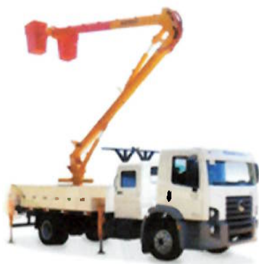
Figura 4-8: Caminhão equipado com duas cestas aéreas isoladas. Fonte: (Leal, 2010)
